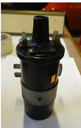
Figure 3 : Bobine (=transformateur)
