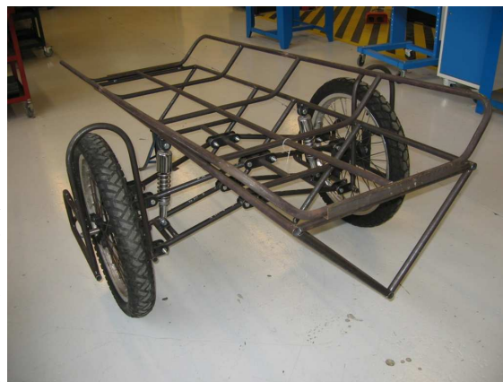
Structure de la remorque de la moto ambulance qui servira au transport des blessés.
