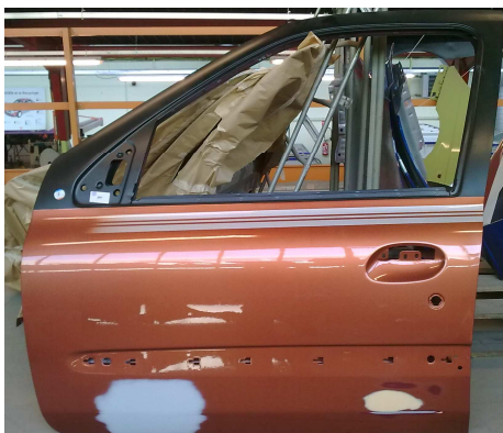
Exemple de réparation à effectuer
