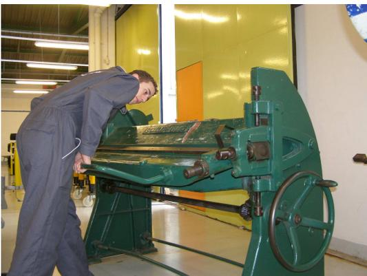
La plieuse manuelle: cette machine permet de plier une tôle jusqu'à 110 degré.
