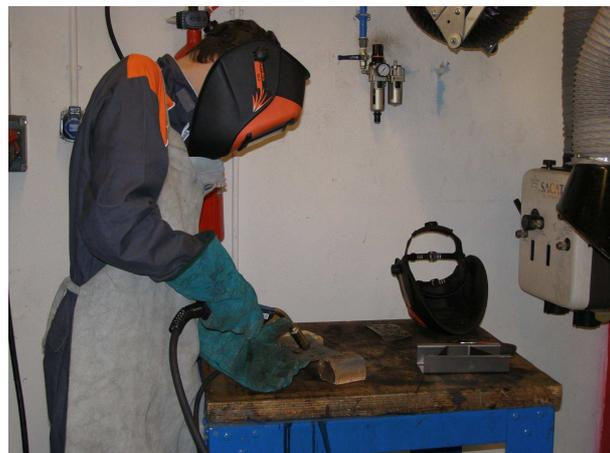
Le soudage par apport de métal. Cette technique permet de lier deux tôles, c'est un soudage inamovible (que l'on ne peut délier sans détruire le moyen de fixation). Il existe plusieurs formes de soudage: MIG, MAG et SERP. (Soudage Electrique par Resistance par Point)
