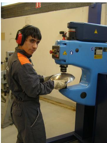
La « Piccolo » est une formeuse à froid, dont le but est de donner forme à une tôle, ici l'élève façonne une coupole (forme de saladier).
