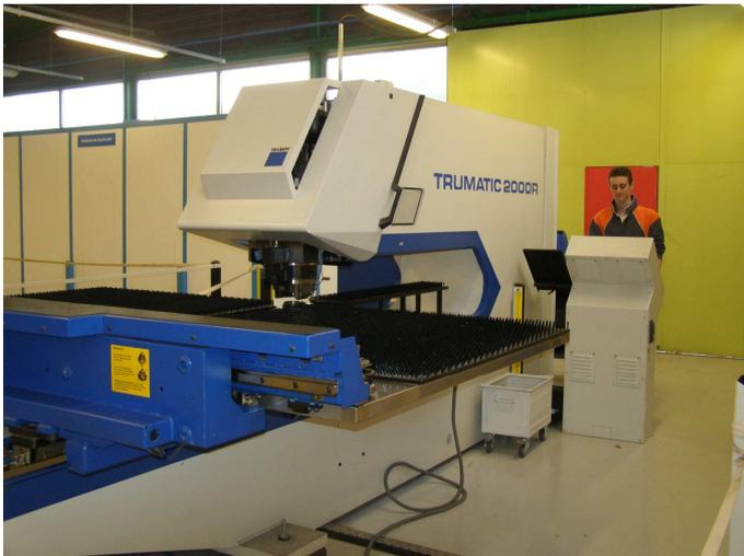
La « TRUMPF » est une poinçonneuse est une machine équipée de sept outils différents, permettant le poinçonnage d'une pièce, c'est-à-dire le découpage d'une pièce de tôle en série. Cette machine est munie d'une commande numérique qui permet de lancer les programmes.
