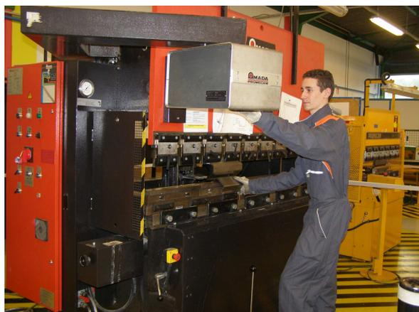
La plieuse numérique permet de réaliser les mêmes tâches mais de façon plus précise. Elle permet de plier des morceaux de tôles plus grands, via une commande numérique.
