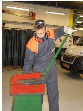
La cisaille manuelle permet de couper de la tôle.
