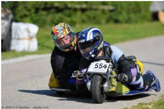
Une caisse à savon (side car) est un véhicule à trois roues qui est conduit par un pilote et qui est dirigé à l'aide d'un singe (personne qui fait le contre poids pour éviter au véhicule de se retourner et faciliter la prise des virages).
