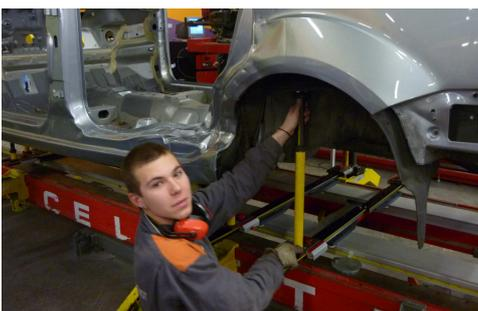
Le banc de mesure « METRO 2000 » est un banc de mesure tridimensionnel, qui consiste à mesurer l'infrastructure du véhicule (le soubassement) lors d'un choc de 2<sup>ème</sup> ou 3<sup>ème</sup> degré afin de définir l'ampleur des déformations et de remettre celui-ci en ligne à l'aide d'une équerre hydraulique.
