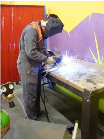
Le soudage sous protection gazeuse avec métal d'apport (M.A.G) ou (M.I.G) consiste à relier des éléments de même nature. Ce procédé est utilisé plus généralement lors de remplacement des éléments inamovibles (partiel ou total). Il existe également un procédé de soudage électrique par résistance et par pression ou par point (S.E.R.P)
