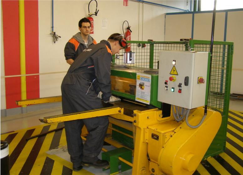
Cette cisaille hydraulique sert à découper des pièces. On peut régler une butée afin de faciliter le calcul du découpage.
