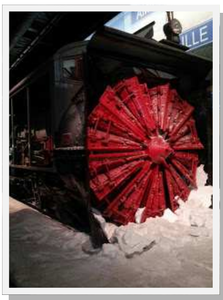
"Fraiseuse" à neige pour dégager les voies.
